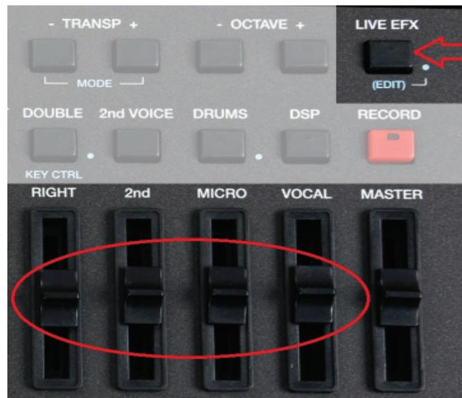
Die **LIVE EFX** LED leuchtet auf. Dies bedeutet das die LIVE EFX Effekte auf den eingestellten Bereich wirken. Zur Steuerung der LIVE EFX können nun die Fader **RIGHT**, **2nd**, **MICRO** und **VOCAL** in Real Time verwendet werden.
