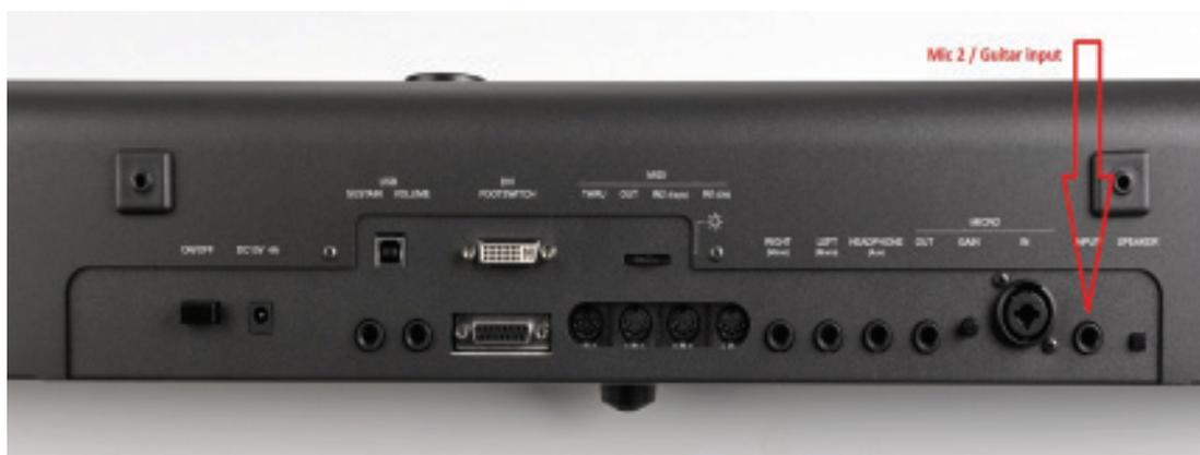
Vergewissern Sie sich dass der **INPUT Lautstärkefader** ganz zurück gezogen ist und der **INPUT Taster** auf **OFF** (LED ist aus) steht BEVOR Sie etwas an den SD7 anschliessen. Sie vermeiden so eventuelle Schäden am internen Lautsprechersystem des SD7!
