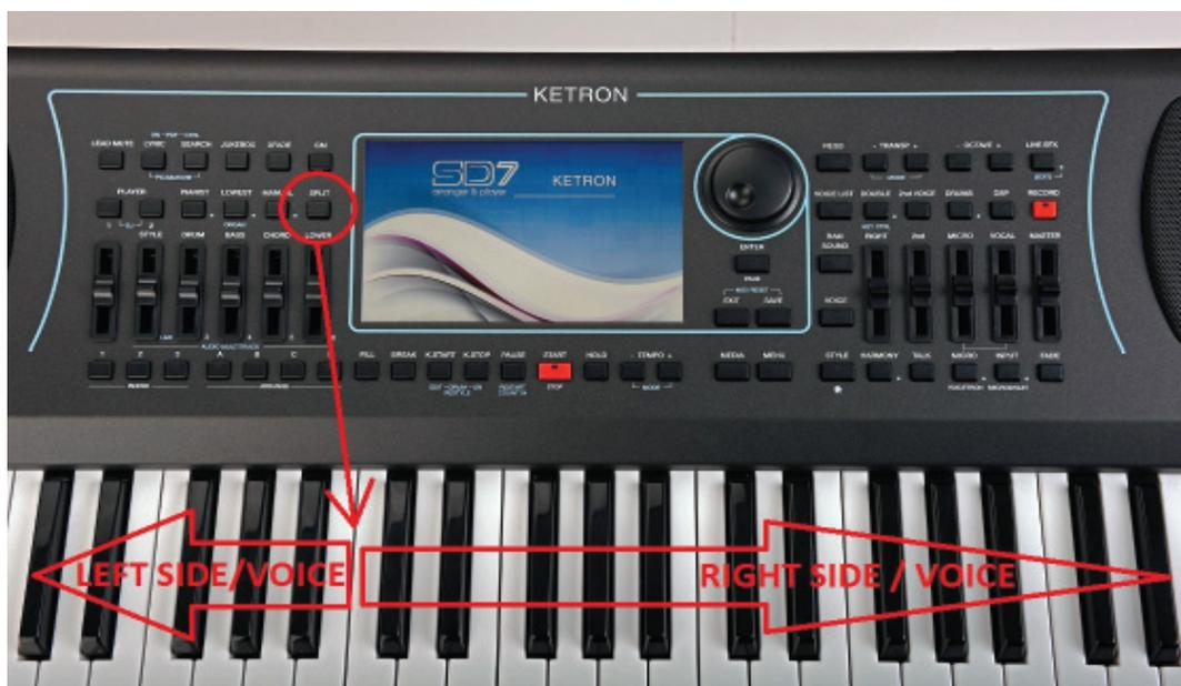
Um einen neuen Splitpunkt auf der Tastatur zu setzen, drücken und halten Sie den Taster **SPLIT** auf dem Bedienfeld links vom Display.
