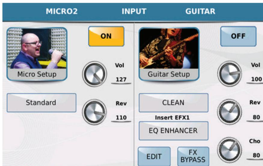
Das Display zeigt zwei Spalten. Die linke Seite ist zuständig für den Mikrofoninput, die rechte Seite für den Gitarreninput. Es kann nur immer eine dieser beiden Quellen benutzt werden.
