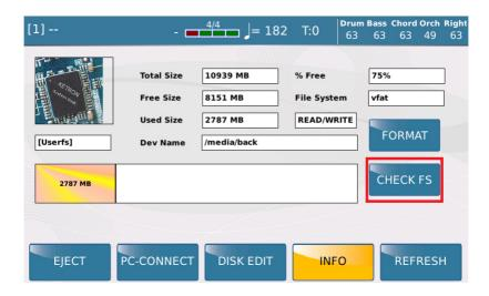
Die Anzeige (Bild unten) wechselt auf "Wait…"(gelb hinterlegt) und der Speicher wird überprüft. Je nach belegtem Speicherplatz kann dies auch mal ein paar Minuten in Anspruch nehmen. Nach der Überprüfung wird das Ergebnis unterhalb des Infobalkens angezeigt. (rot markiert)
