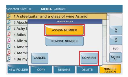
Es werden nun ALLE Files eines Ordners nummeriert, ein blauer Balken im Auswahlfenster zeigt bei einer höheren Anzahl von Files den Bearbeitungsfortschritt an. Nach dem Nummerieren steht im Display vor jeder Nummer ein kleines, gelbes Schloßsymbol. (Bild unten)
