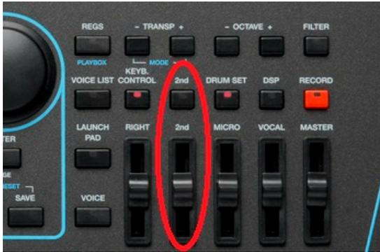
Bild 5: 2<sup>nd</sup> Voice Taster und Fader
