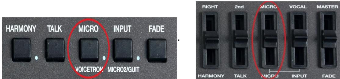
Bild 162: MICROPHONE – Taster und Lautstärkefader
