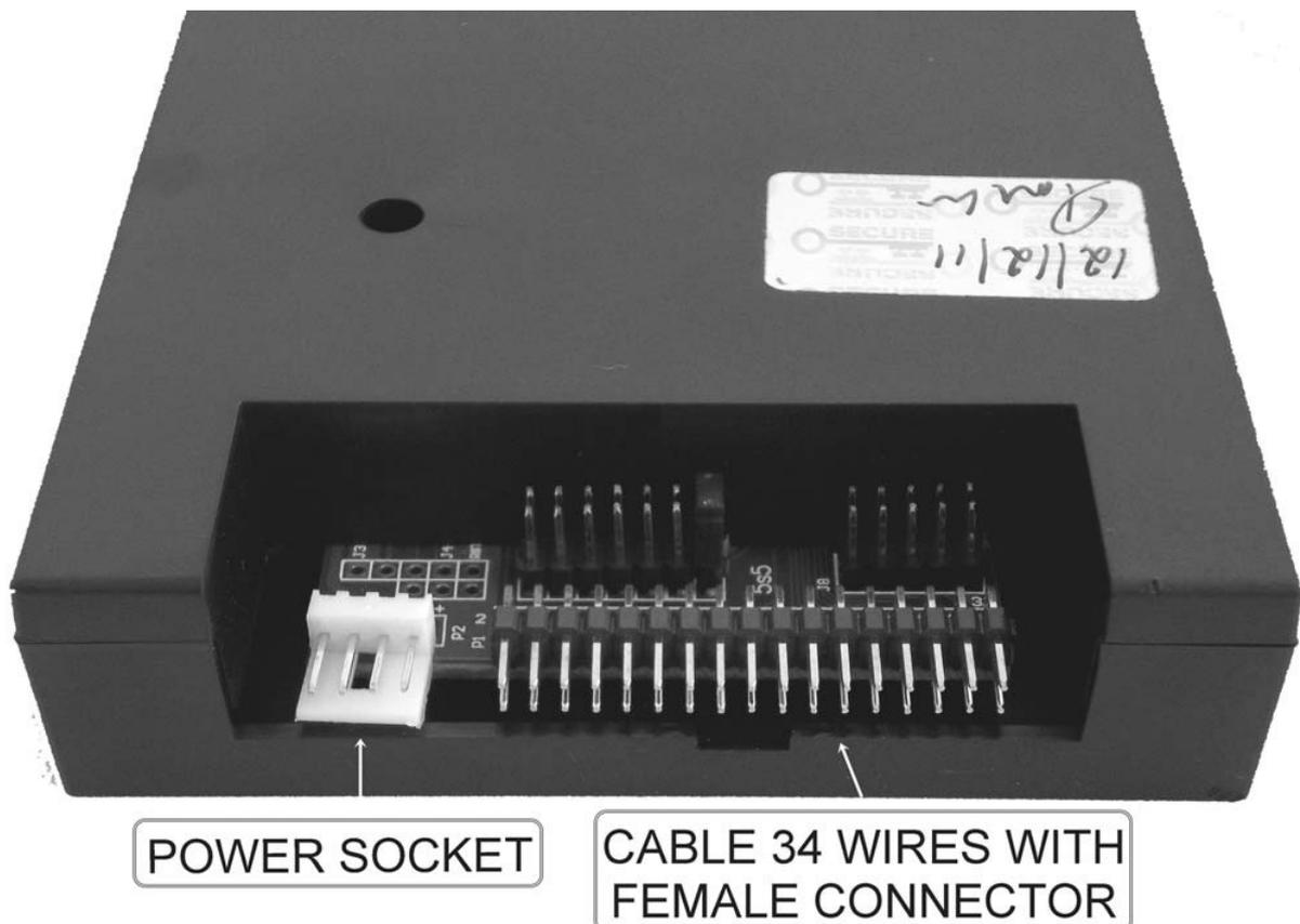
Auf der Rückseite befinden sich die Anschlüsse für Stromversorgung und das 34pin Interface. Das USB Floppy Laufwerk wird an der Stelle des bisherigen Diskettenlaufwerkes eingebaut und auf die gleiche Weise angeschlossen wie das Diskettenlaufwerk zuvor. Stellen Sie sicher, daß die Polarität der Stromversorgung korrekt ist.
